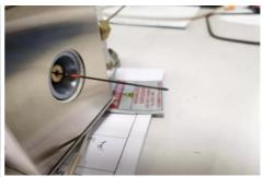
如果是该种情况,一般可以参照编号1:空杯的检测结果辅助判定,因为热裂解石英管、热裂解针、玻璃衬管(分流)污染的情况下,一般空杯测试也会有同样的检出。
