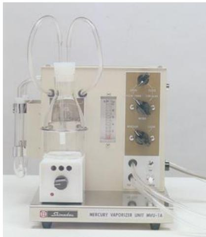
图1 岛津MVU-1A 冷汞发生器
